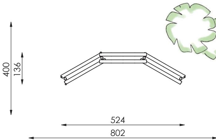
Das Gerät wird als reine Sitzgelegenheit gewertet. Deshalb ist der Einbau auch ohne falldämpfenden Untergrund gestattet !
