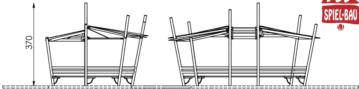
Das Gerät wird als eine Sitzgelegenheit gewertet. Deshalb ist der Einbau auch ohne falldämpfenden Untergrund gestattet !
