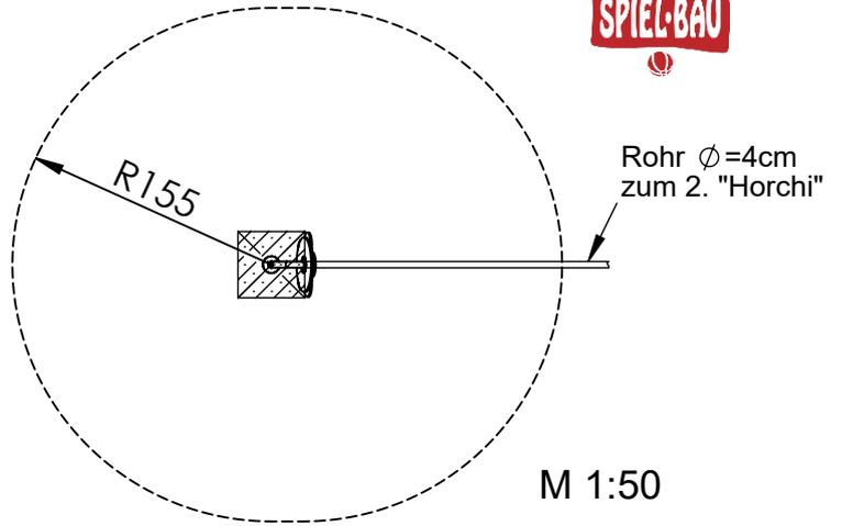
Verbindung mit flexibles Kunststoffrohr ( $\varnothing 4\text{cm}$ ) je nach Abstand der Rufsäulen bauseits!
