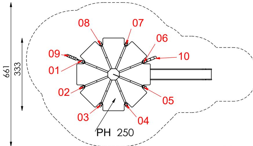
Maximale freie Fallhöhe nach EN 1176: 250 cm
