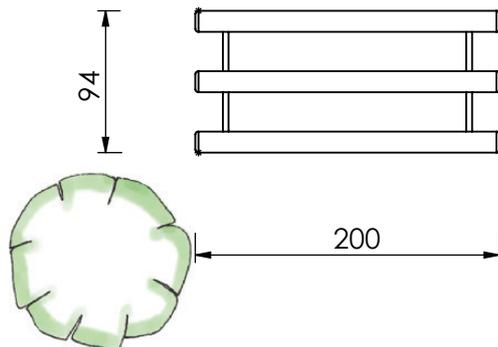
Das Gerät wird als reine Sitzgelegenheit gewertet. Deshalb ist der Einbau auch ohne falldämpfenden Untergrund gestattet !
