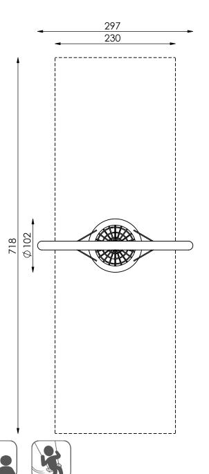
Maximale freie Fallhöhe nach EN 1176: 135 cm
